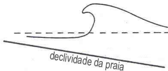
Figura 23: Modelo esquemático de uma Onda Mergulhante
