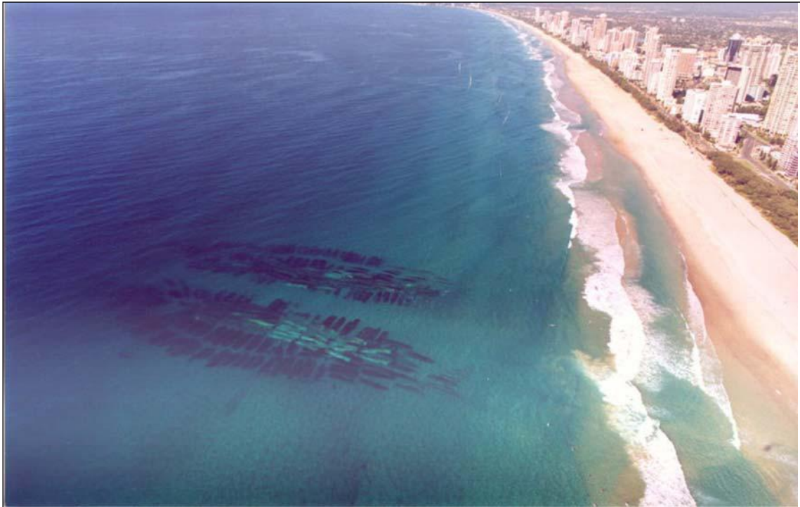
Figura 3: RAM utilizado na praia de Narrowneck, Gold Coast , Austrália
