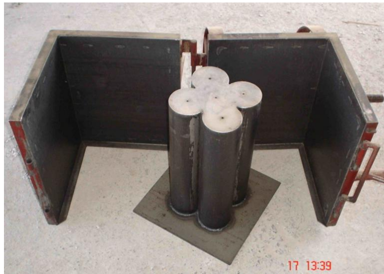
Figura 31: Fôrma dos recifes aberta.
