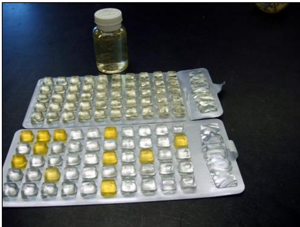
Figura 4 - Análise de coliformes pelo método de Coli-Alert. A cartela com células em amarelo indica a presença de coliformes.
