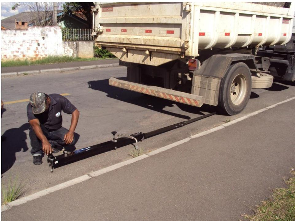
**Figura 12 – Ajuste do pé traseiro da Viga Benkelman**
