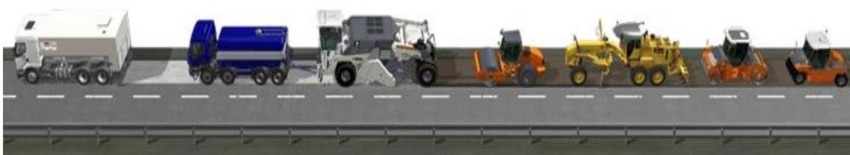
**Figura 7 - Trem de reciclagem profunda de pavimento *in situ* com adição de cimento Portland**
