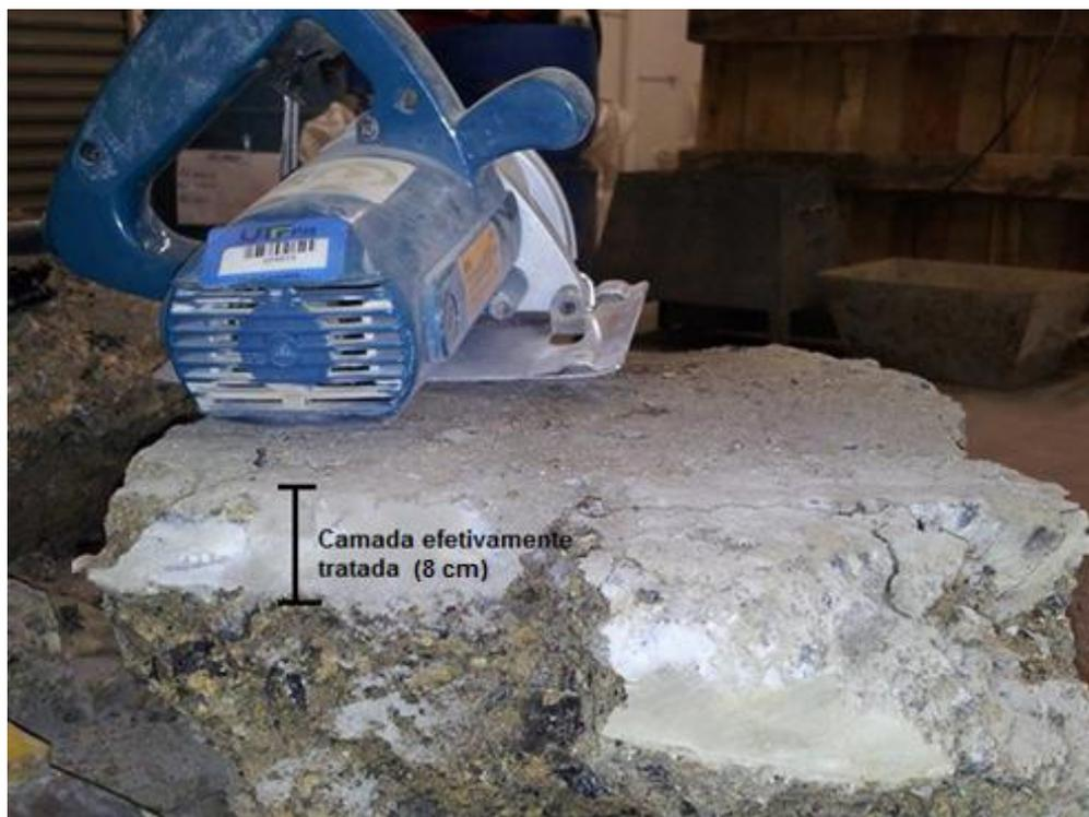
**Figura 13 - Amostra retirada da rua reciclada com indicação da camada tratada pelo procedimento de reciclagem profunda com adição de cimento Portland
