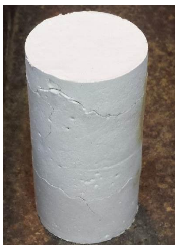
Figura 23 - Corpo de prova de pasta de fosfogesso com fissuras
