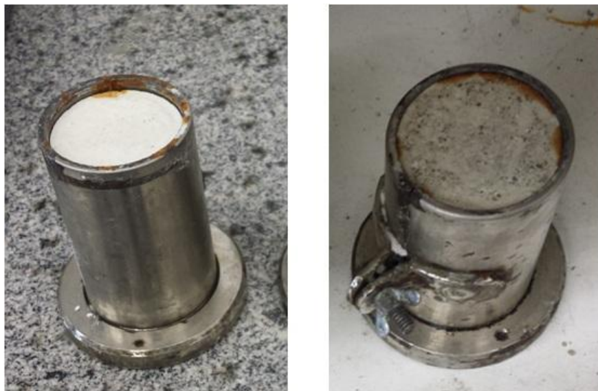
Figura 26 - Corrosão dos moldes
