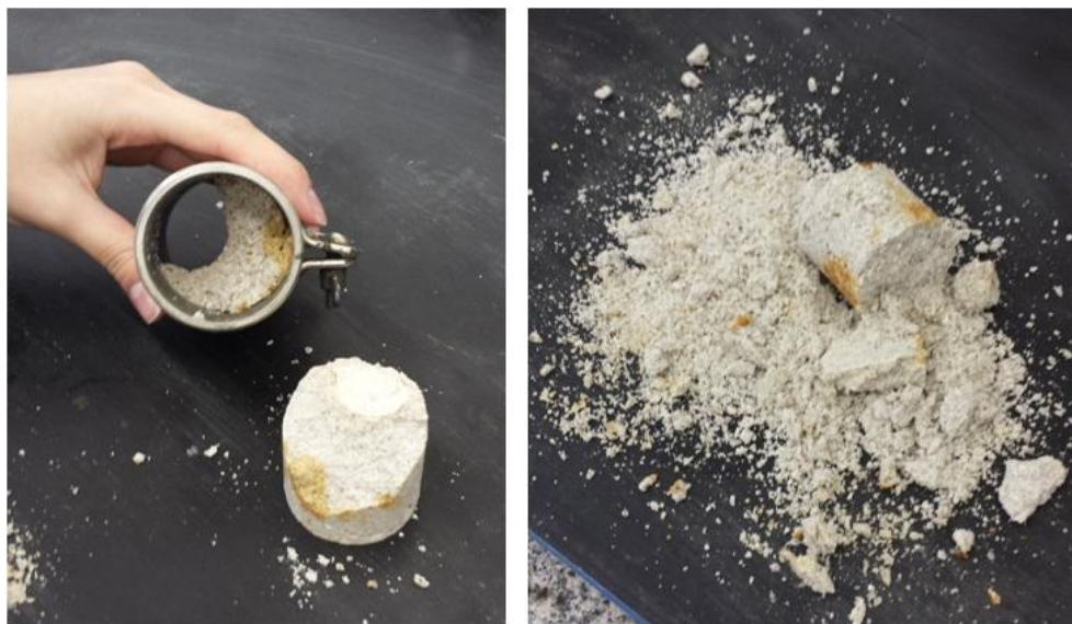
Figura 24 - Corpo de prova de argamassa de fosfogesso sendo desmoldado
