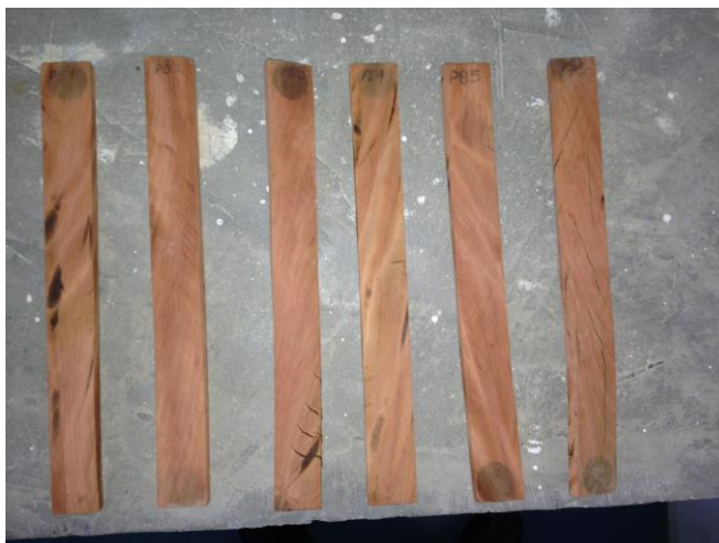
Imagem 2 – Corpos de prova de peroba. Fonte: Autoria própria.
