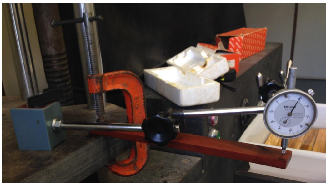
Imagem 5 – Ensaio de flexão simples reta. Fonte: autoria própria.
