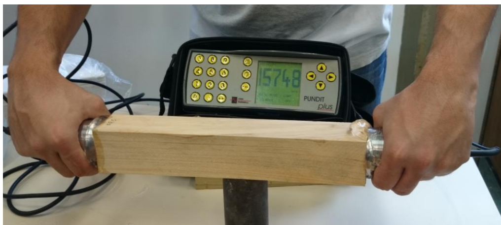
Imagem 6 – Ensaio de Ultrassom. Fonte: autoria própria.
