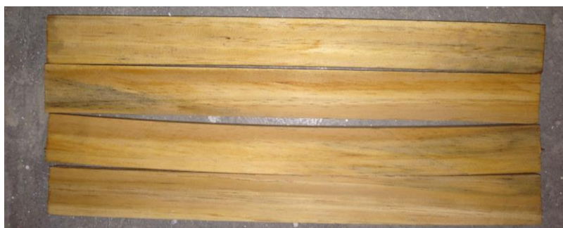
Imagem 4 – Corpos de prova de Pinus. Fonte: Autoria própria.
