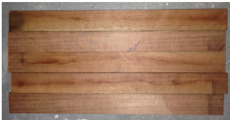
Imagem 1 – Corpos de prova de cedro Fonte: Aatoria própria.
