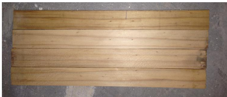
Imagem 3 – Corpos de prova Araucária. Fonte: autoria própria.
