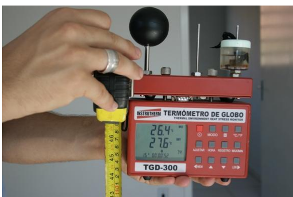
Imagem 4: Termômetro de globo posicionado à 1,20m do piso, na linha da base dos sensores, no centro do ambiente Fonte: Autoria própria
