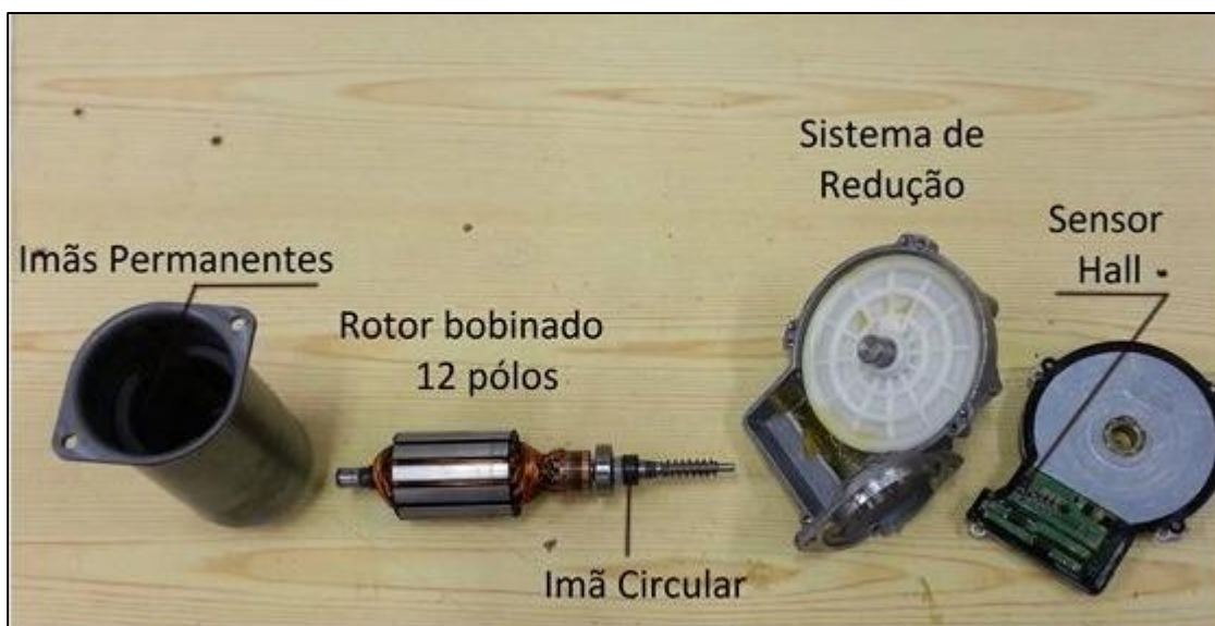
Figura 31 – Partes do Motor Doga 319. Fonte: Autorial Própria.
