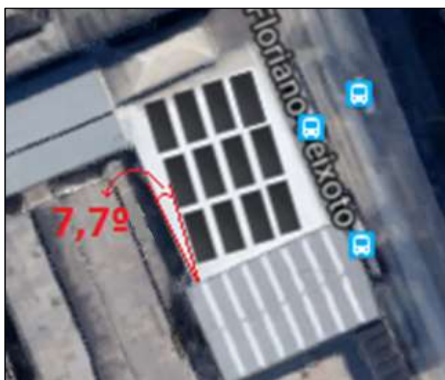
Figura 21 – Layout da instalação dos coletores solares.
