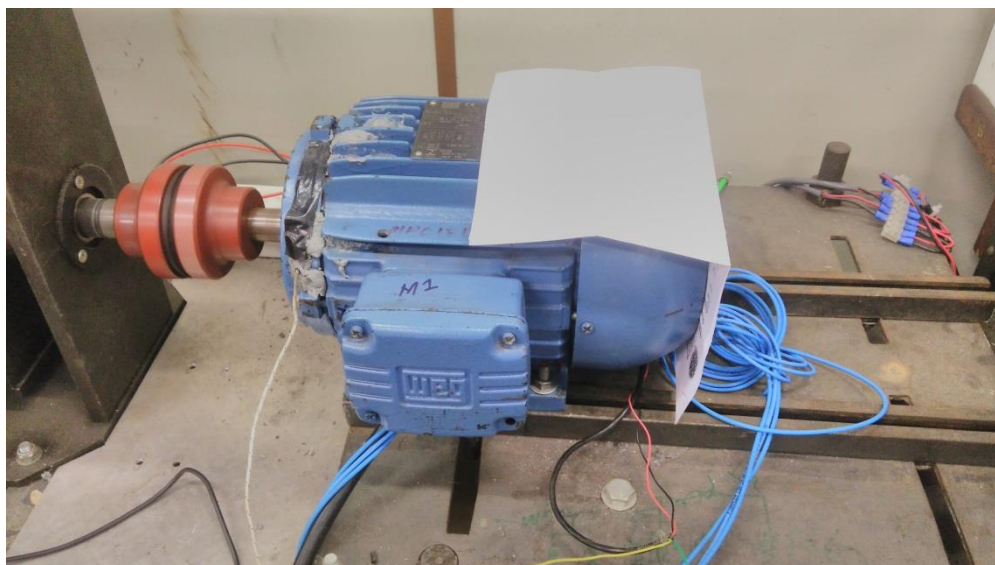
Figura 6.9: Bloqueio de ventilação do MIT em fator de serviço a 115%
