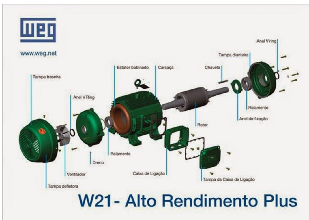
Figura 2.1: Vista Explodida de um Motor de Indução.
