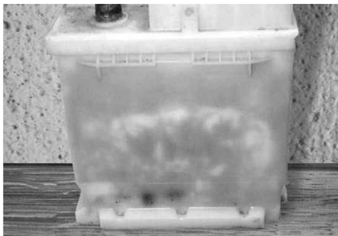
Figura 5 – Bateria com descarga profunda e “sulfatagem” (sulfatação) Fonte: MOURA S.A (2007).
