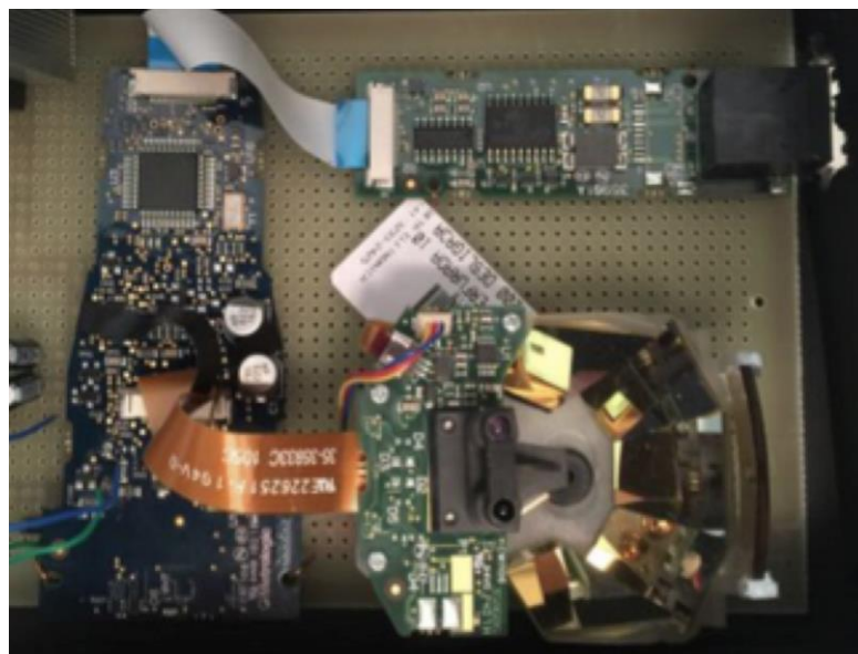
Figura 21 - Peças do leitor acopladas a matriz de contatos
