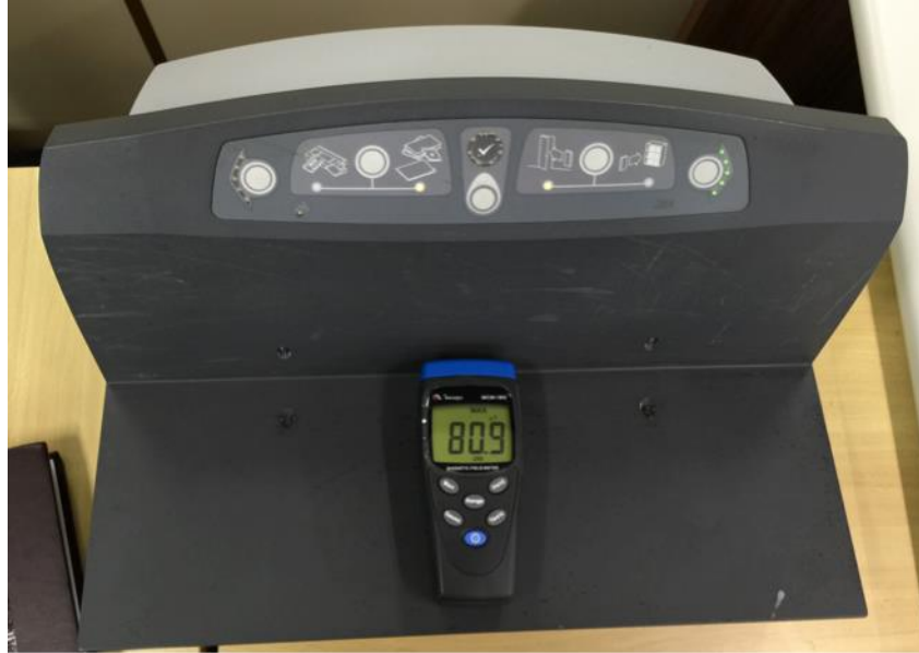
Figura 19 - Medição de campo magnético em um desmagnetizador comercial. Fonte: Autoria própria.
