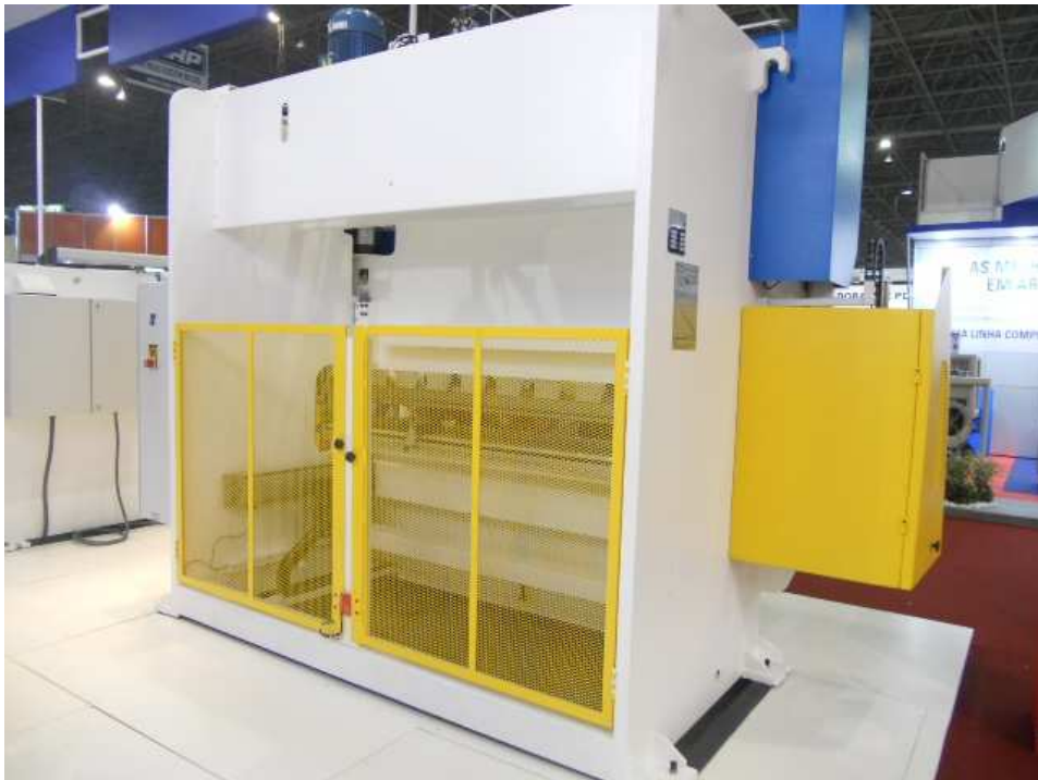
Figura 11 - Proteção física na parte de traz da dobradeira Fonte: OPERATRIX (2014)
