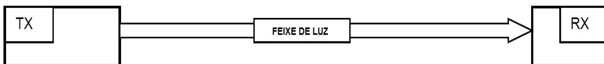
Figura 29 - Feixe de luz do sistema de segurança
