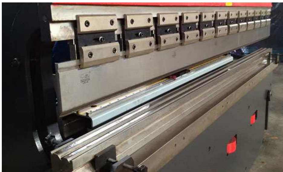
Figura 10 - Zona de prensagem da máquina dobradeira Fonte: WORLD (2014)
