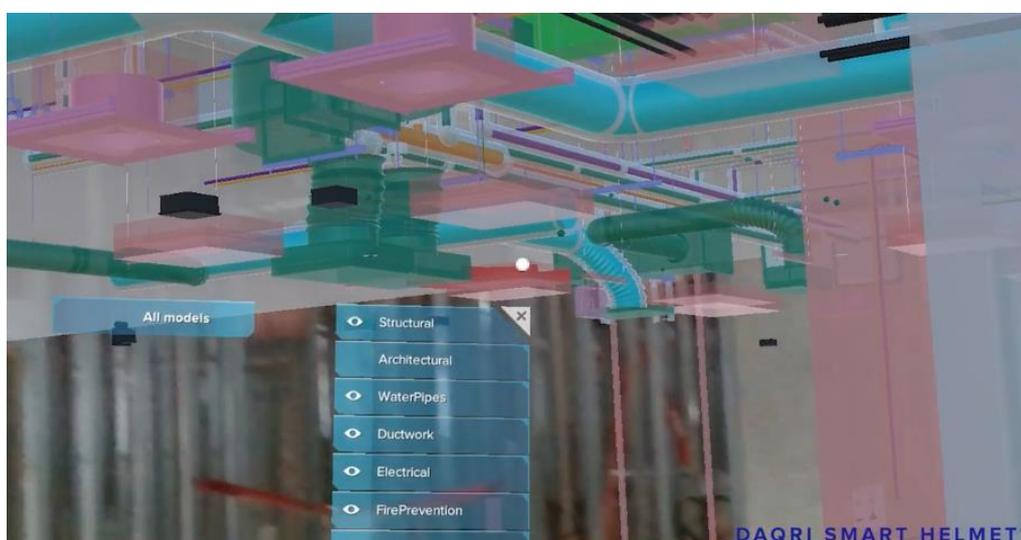
Figura 26: Visão do operador com o capacete: Detalhes construtivos. Fonte: Daqri.
