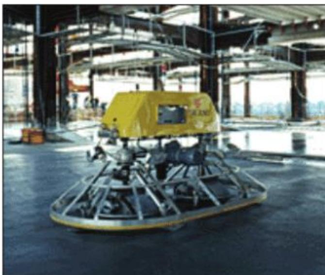
Figura 20: Robô "*SurfRobo*" da Takenaka. Fonte: (BALAGUER; ABDERRAHIM, 2008).
