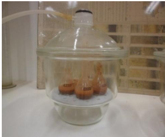
Figura 3.4 – Detalhe do ensaio para determinação da massa específica.
