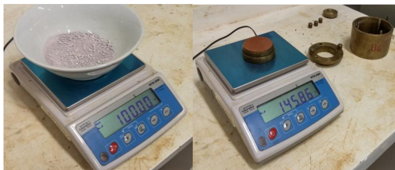
Figura 3.7 – Verificação da quantidade de material necessária para efetuar o ensaio.
