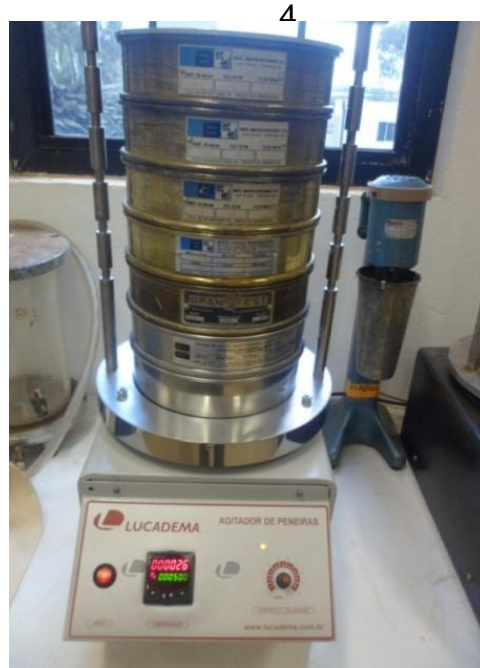
Figura 3.1 – Agitador de peneiras utilizado no ensaio de peneiramento do solo
