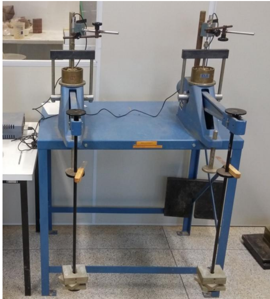
Figura 3.9 – Prensa de adensamento utilizada para o desenvolvimento do ensaio proposto.
