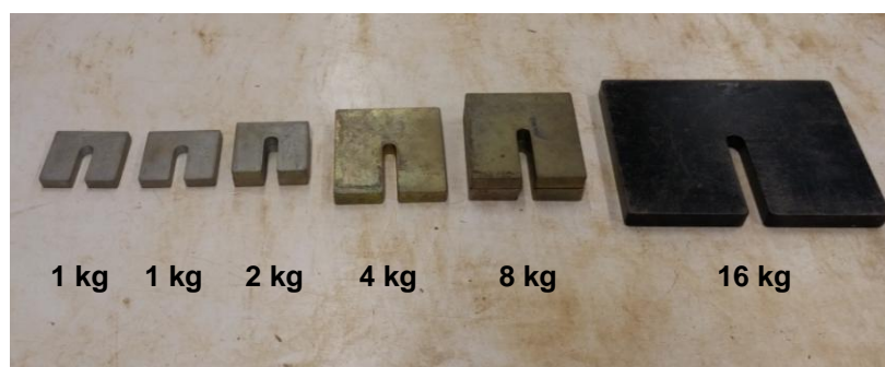
Figura 3.10 – Representação dos pesos utilizados e a sequência de aplicação.
