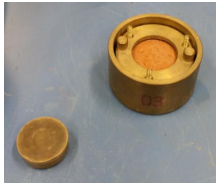
Figura 3.8 – Dispositivo contendo a célula de adensamento com a amostra compactada.
