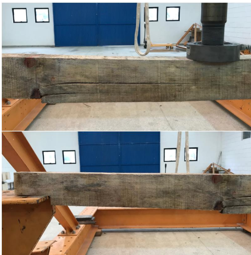
Figura 35 - Ruptura da viga AR01
