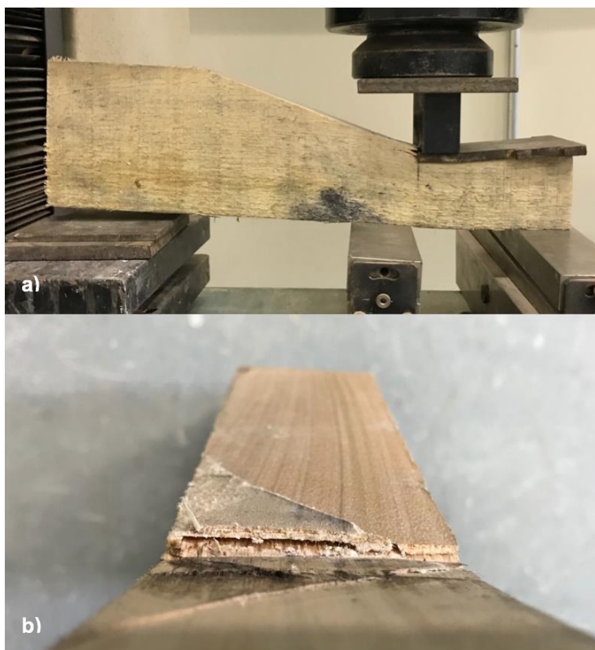
Figura 44 – Amostra 7: a) momento da ruptura; b) fissuras no entalhe
