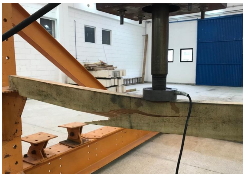
Figura 39 - Ruptura da viga ER01
