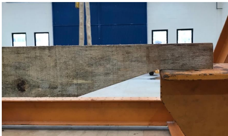
Figura 28 - Detalhe no apoio do entalhe para ensaio de flexão simples
