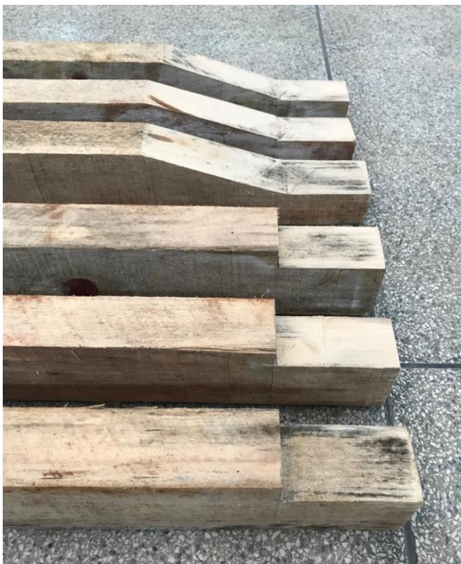
Figura 25 - Vigas com entalhes finalizados
