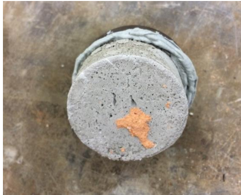
Figura 17 - Pequena parte do bloco arrancado em ensaios de aderência Fonte: Aatoria própria (2017).
