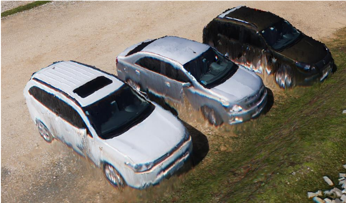
Figura 23 – Detalhe de modelo digital de elevação gerado no software Photoscan® Fonte: Autoria própria (2016).
