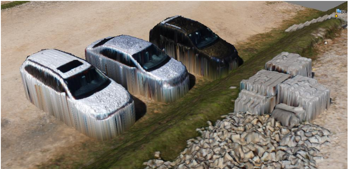
Figura 20 – Detalhe de modelo digital de elevação gerado no software Photoscan ® Fonte: Autoria própria (2016).
