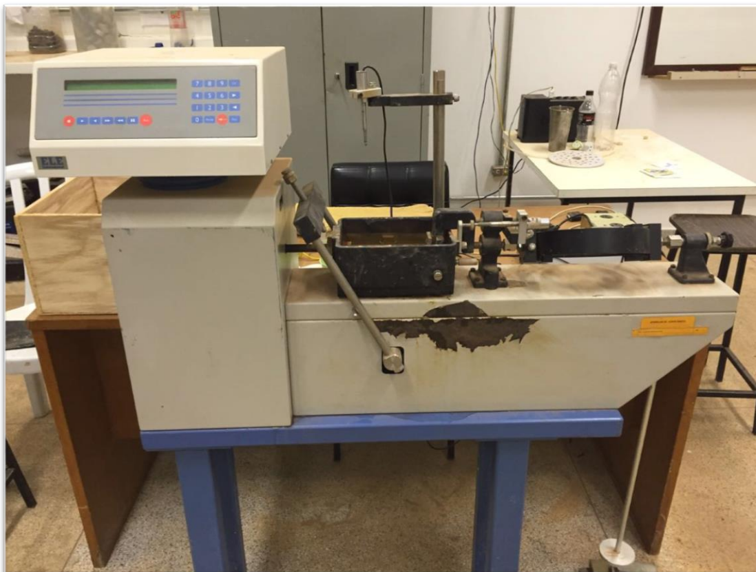
Figura 18 – Equipamento de ensaio para cisalhamento direto Fonte: Autoria própria.
