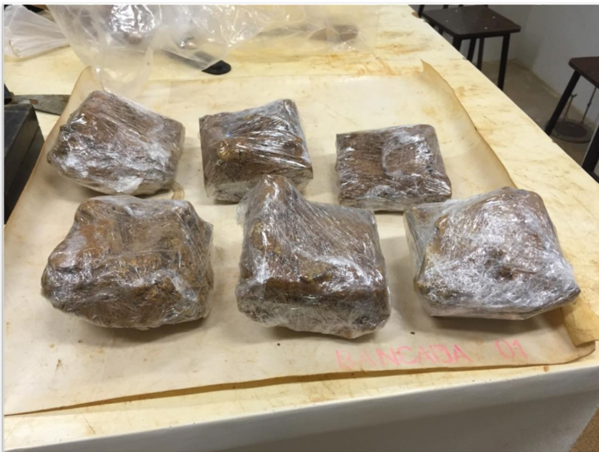
Figura 17 – Amostra indeformada de solo do talude Fonte: Autoria própria.
