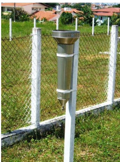
Figura 6 – Aparelho Pluviômetro Instalado “in loco”
