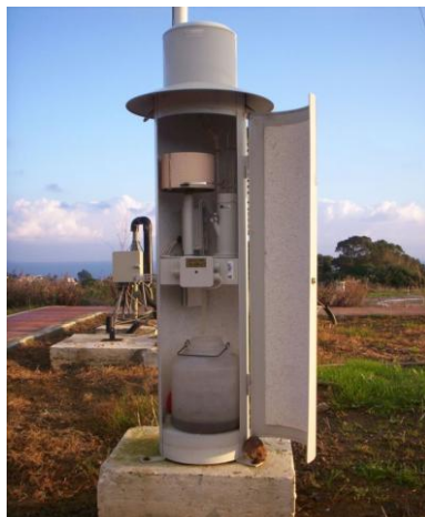
Figura 5 – Aparelho Pluviógrafo “in loco”
