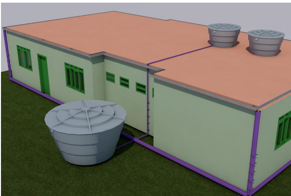
Figura 24 - Vista superior de casa de habitação com instalações do sistema de aproveitamento de água da chuva referente ao cenário 1
