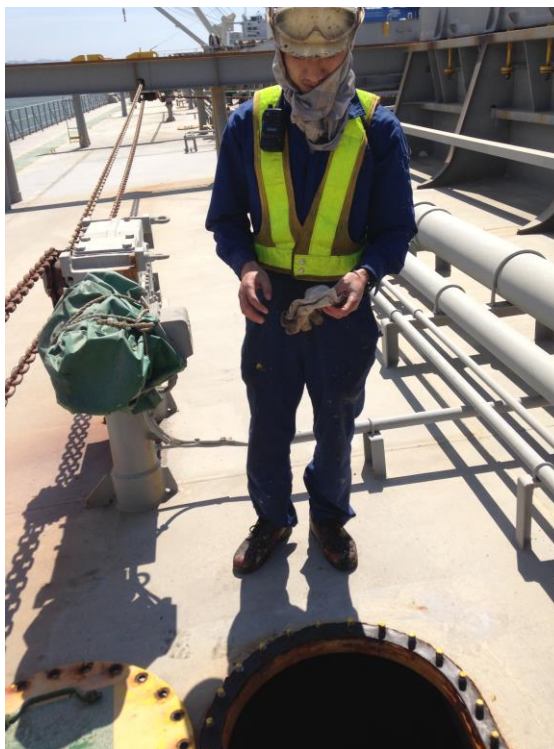
Figura 10 - Membro da tripulação coletando a água de lastro por meio da escotilha de acesso aos tanques.
