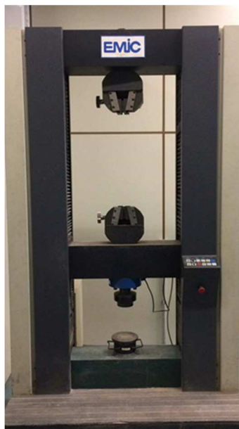
Figura 12 - Prensa EMIC, modelo DL 30000N. Fonte: Autoria própria
