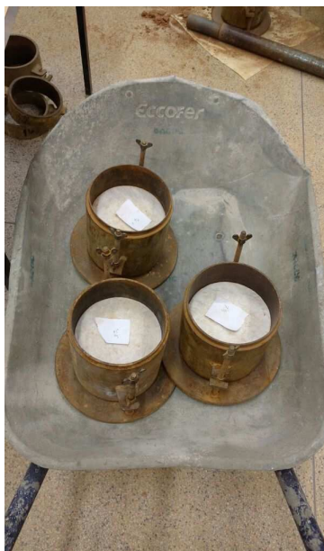
Figura 13 - Amostras de CBR retiradas da imersão. Fonte: Autoria própria
