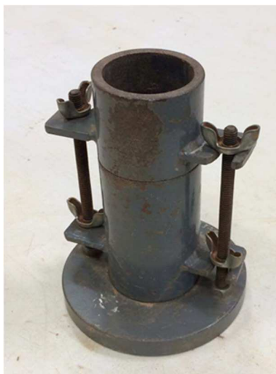
Figura 11 - Molde cilíndrico modificado utilizado em RCS. Fonte: Autoria própria
