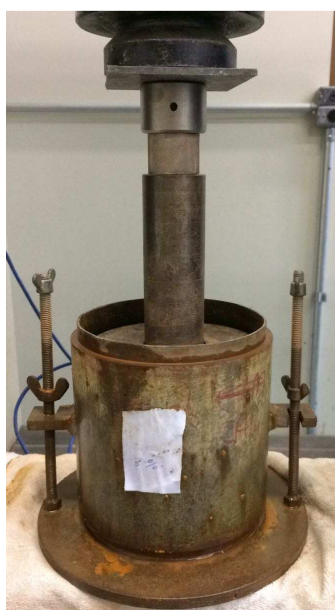
Figura 14 - Amostra de CBR sendo submetida ao ensaio de penetração. Fonte: Autoria própria.
