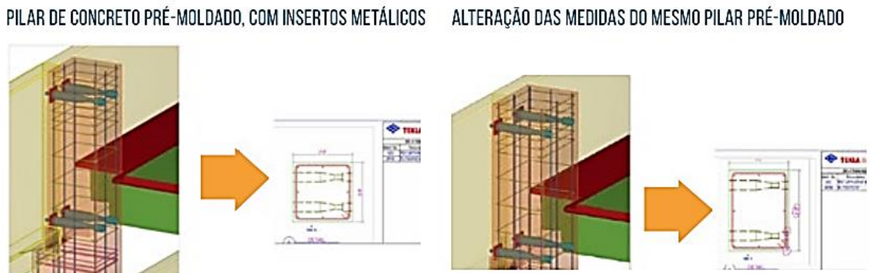
Figura 6 - Demonstração de Alteração de Medidas e a Atualização Automática Fonte: CBIC (2016, p. 36)
