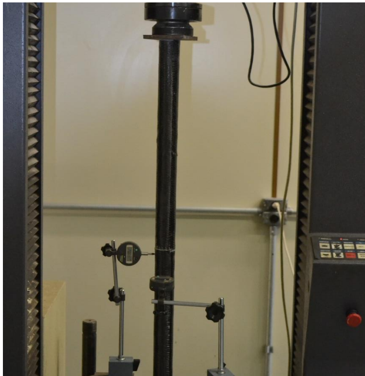
Figura 15 - Ensaio de compressão centrada com transdutores de deslocamento
