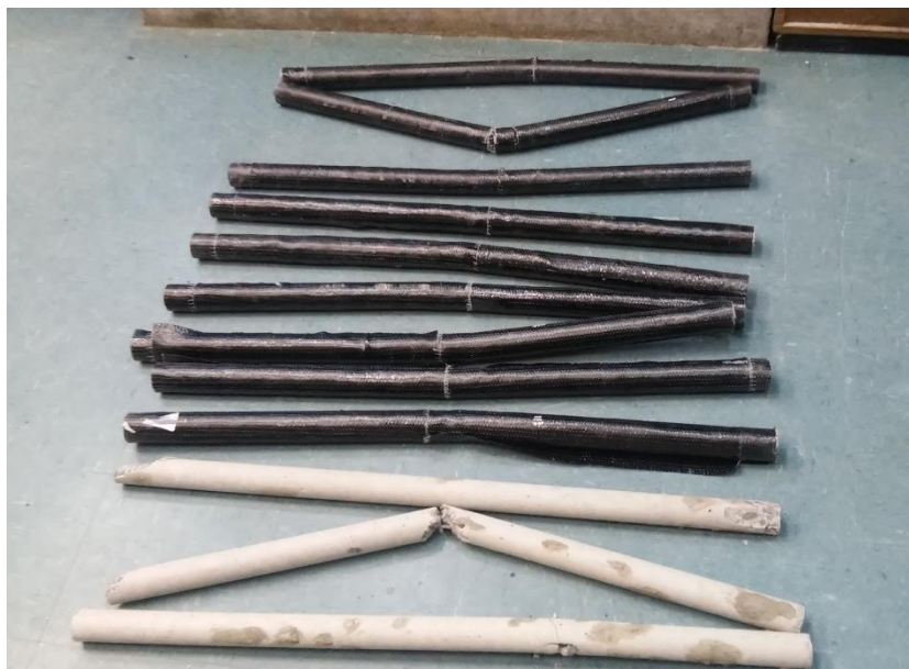
Figura 16 - Pilares após a ruptura
