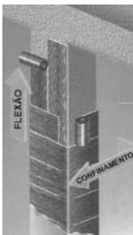
Figura 5 - Confinamento de pilares com sistemas compostos de fibra de carbono (CFRP)
