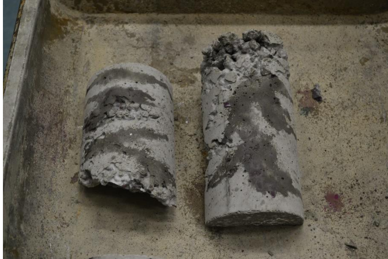
Figura 28: Corpos de prova submetidos à compressão diametral e com asperção de fenolftaleína após segunda semana de carbonatação
