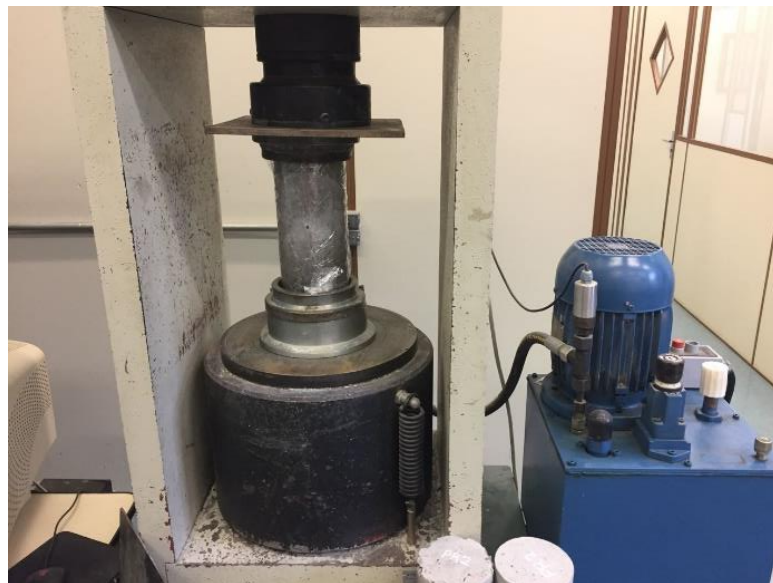
Figura 25: Ensaio de resistência à compressão axial
