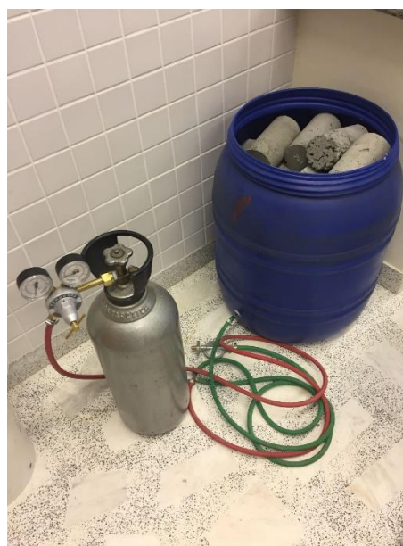
Figura 18: Câmara de carbonatação aberta com os corpos de prova antes do início do processo
