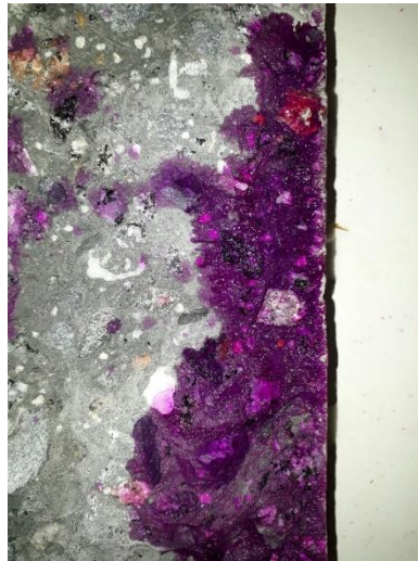
Figura 22: Corpo de prova após aspersão de fenolftaleína com duas semanas de realcalinização, com ruptura diametral
