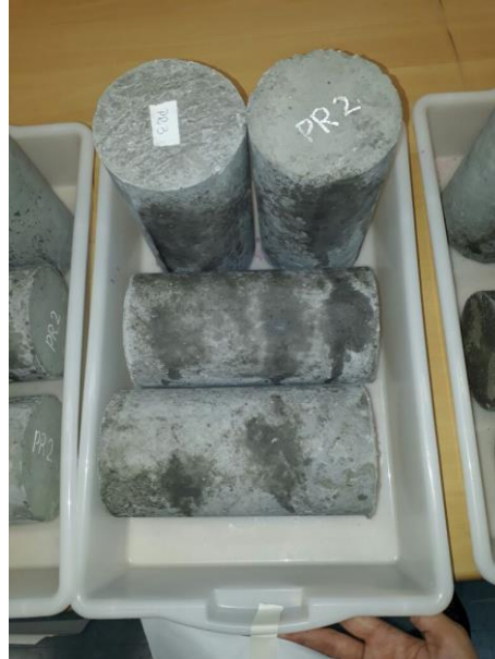
Figura 21: Corpos de prova após aspersão de fenolftaleína com uma semana após realcalinização
