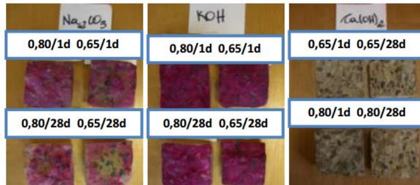
Figura 9 - Corpos de prova após 9 semanas de tratamento (RAQ) aspergidos com fenolftaleína . Fonte: ARAÚJO (2009).
