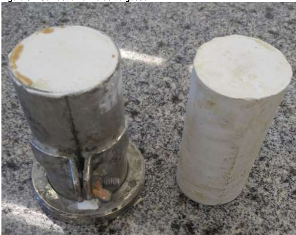
Figura 9 – Corrosão no molde de gesso
