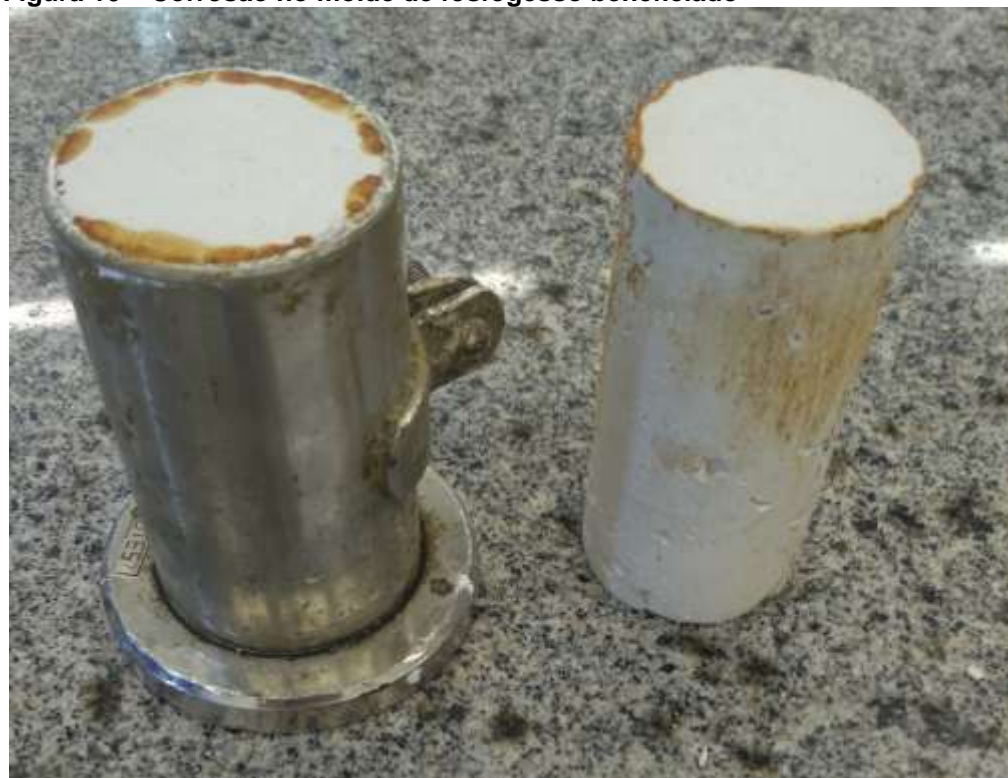
Figura 10 – Corrosão no molde de fosfogesso beneficiado
