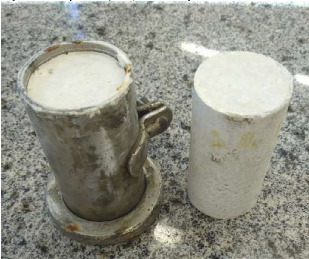
Figura 11 – Retração no corpo de prova de fosfogesso in natura
