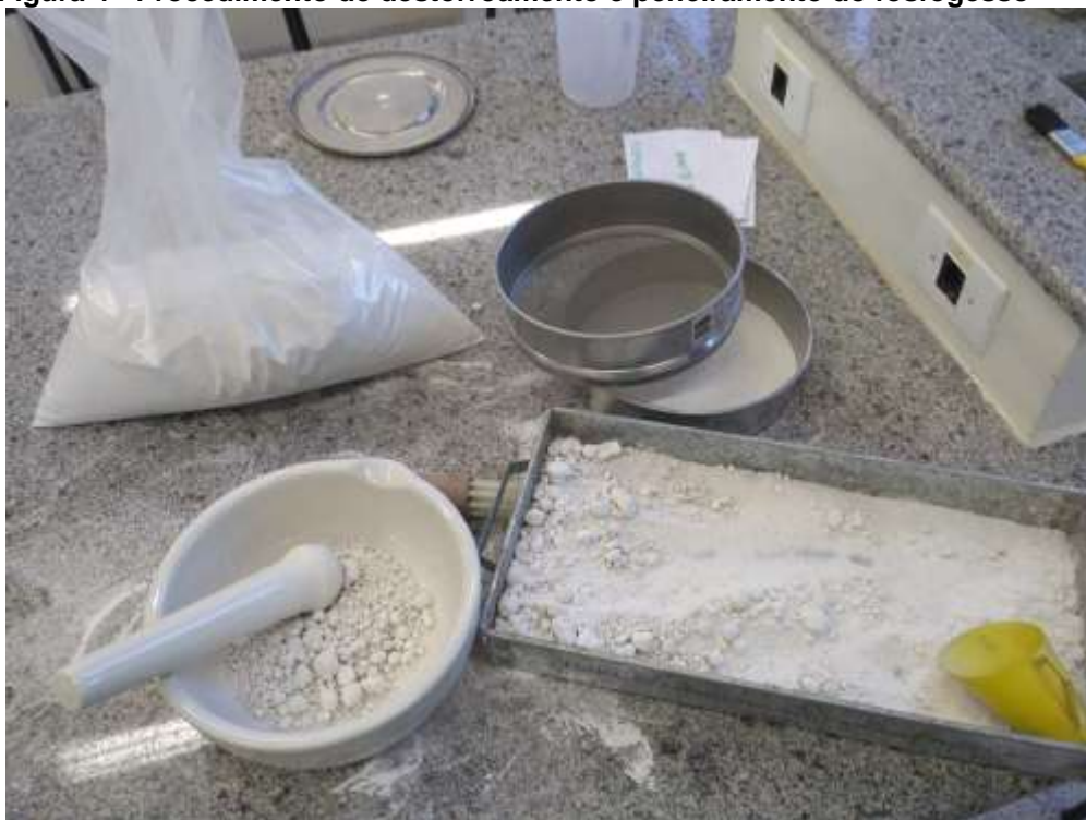
Figura 4 - Procedimento de destorroamento e peneiramento do fosfogesso
