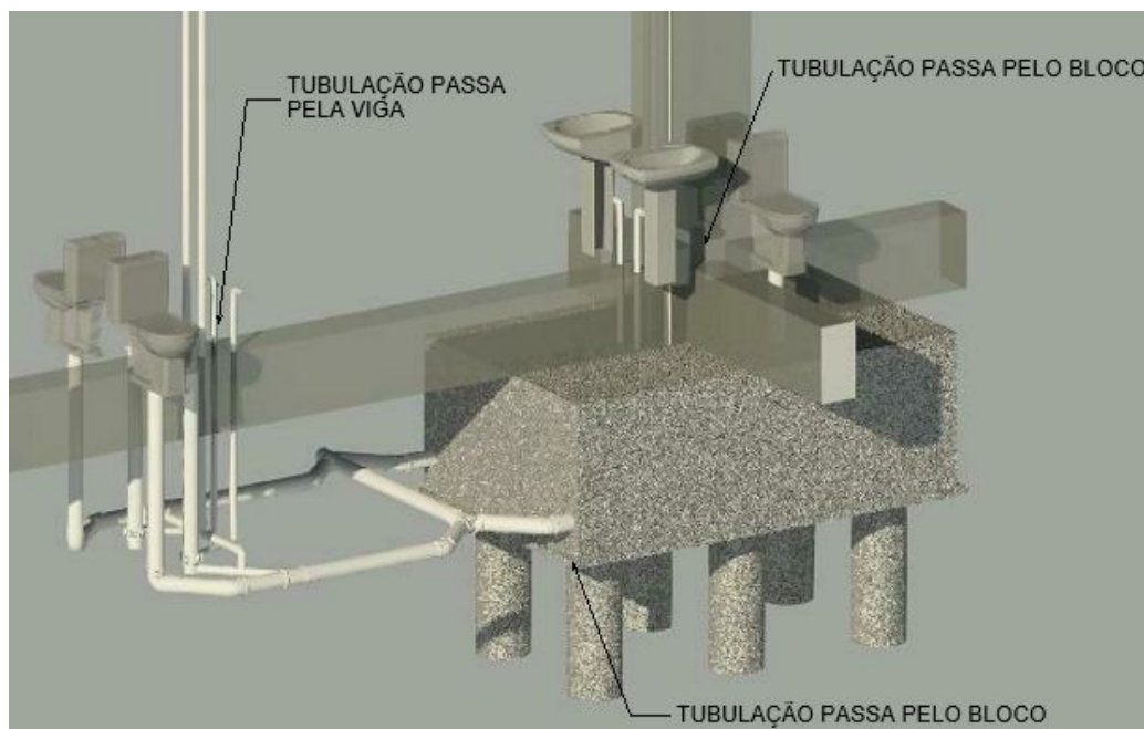
Figura 54: Tubulações sanitárias passando dentro de blocos de estacas e vigas, ambiente 51/52/53 Fonte: Autores
