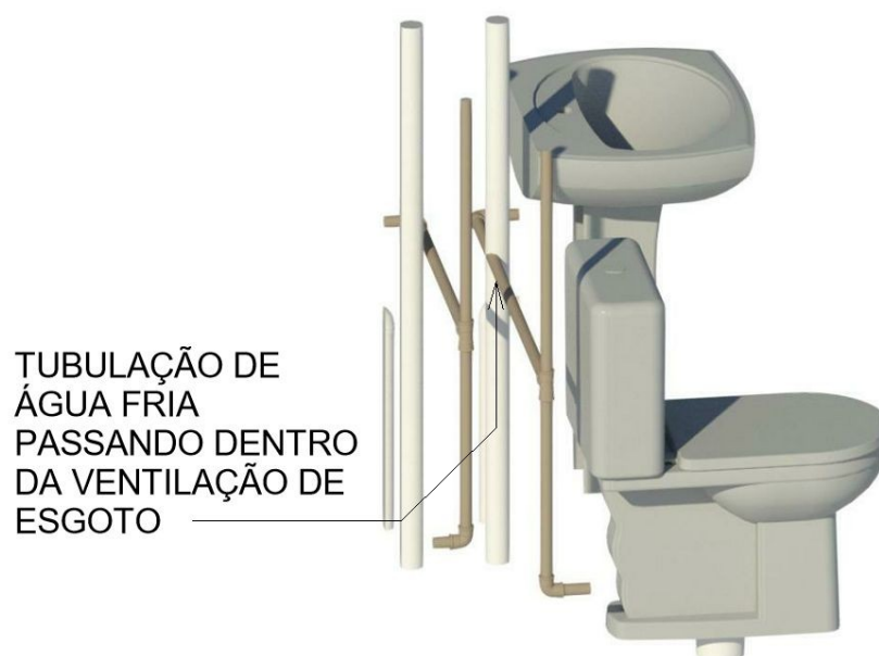
Figura 64: Colisão de tubulações hidráulicas e sanitárias no ambiente 53 Fonte: Autores
