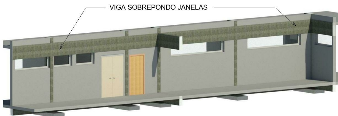
Figura 17: Viga passando dentro de elementos arquitetônicos no ambiente 11/12/14/15/18/19/22 Fonte: Autores
