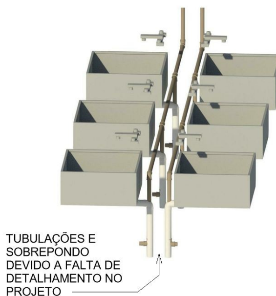
Figura 65: Colisão de tubulações hidráulicas e sanitárias nos ambientes 66 e 67 Fonte: Autores
