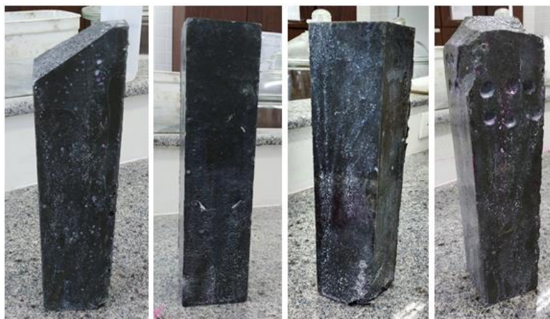
Figura 13 - Concentração superficial de cloretos no concreto de pós-reativos. Fonte: a autora (2018).
