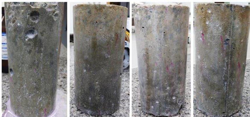
Figura 12 - Concentração superficial de cloretos no concreto convencional. Fonte: a autora (2018).
