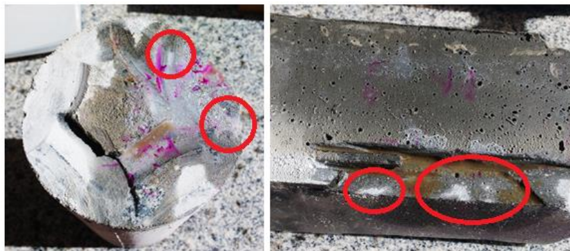
Figura 14 - Penetração de cloretos no CCV (esquerda) e no CPR (direita)
