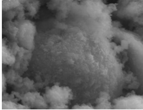
Figura 1 - Formação de etringita em pasta de cimento com 1 dia de idade Fonte: Adaptado de XU et al. , 2012
