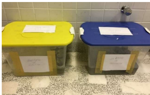
Figura 17 - Corpos de prova em contato com as soluções agressivas de sulfato de cálcio e magnésio Fonte: A autora, 2018
