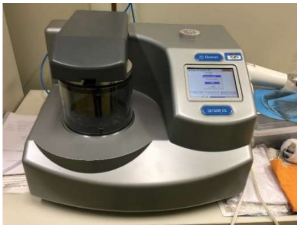
Figura 21 - Aplicação de película de ouro em equipamento a vácuo Fonte: A autora, 2018
