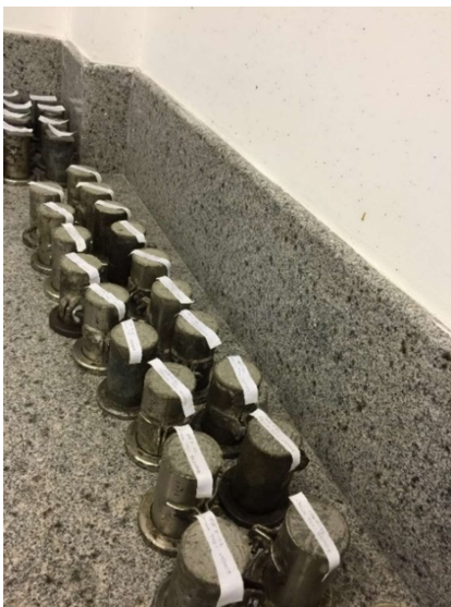
Figura 15 - Corpos de prova secando à temperatura ambiente Fonte: A autora, 2018
