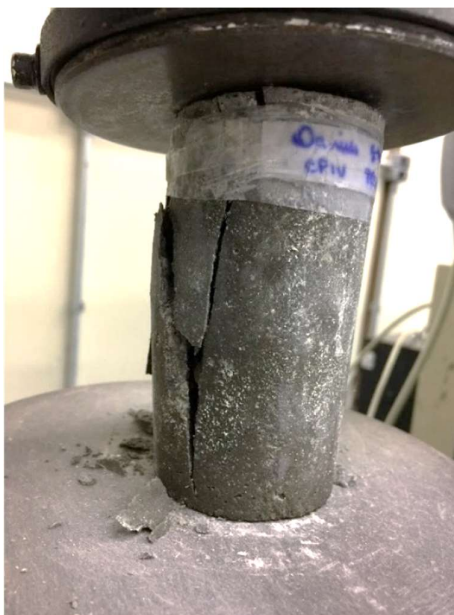
Figura 26 - Aspecto do CP durante o ensaio de resistência à compressão Fonte: A autora, 2018
