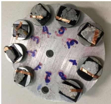
Figura 20 - Fragmentos dos corpos de prova após ruptura preparados para a MEV. Fonte: A autora, 2018
