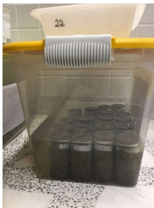
Figura 18 - Corpos de prova em contato com a solução agressiva de sulfato de sódio Fonte: A autora, 2018
