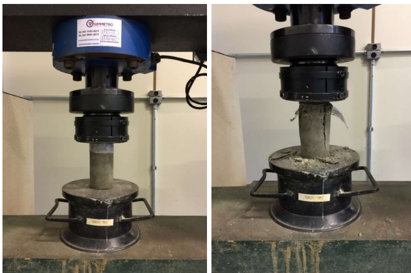
Figura 19 - Ruptura dos corpos de prova Fonte: A autora, 2018
