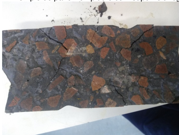
Figura 9 – Exemplo de paver rompido e com superfície regularizada
