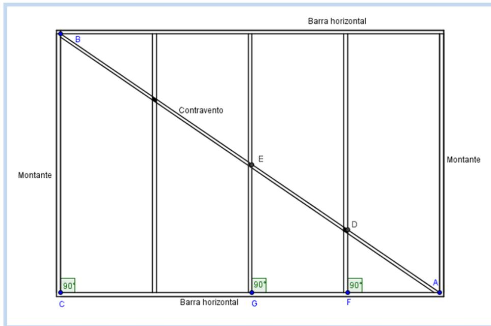
**Figura 17: Estrutura da parede lateral**
