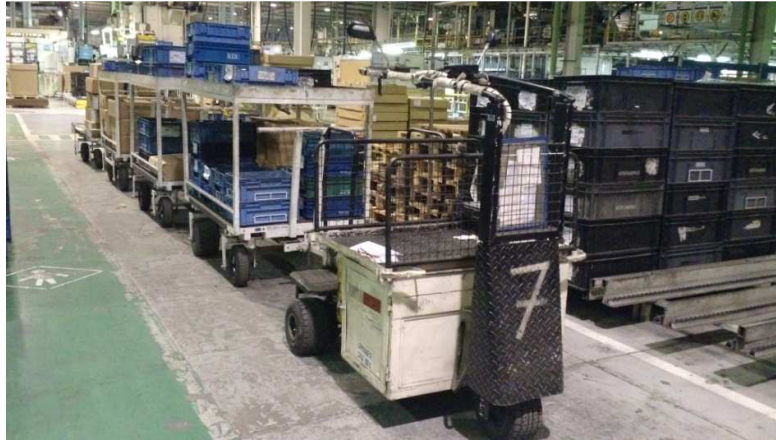
Figura 21: Trem de abastecimento
