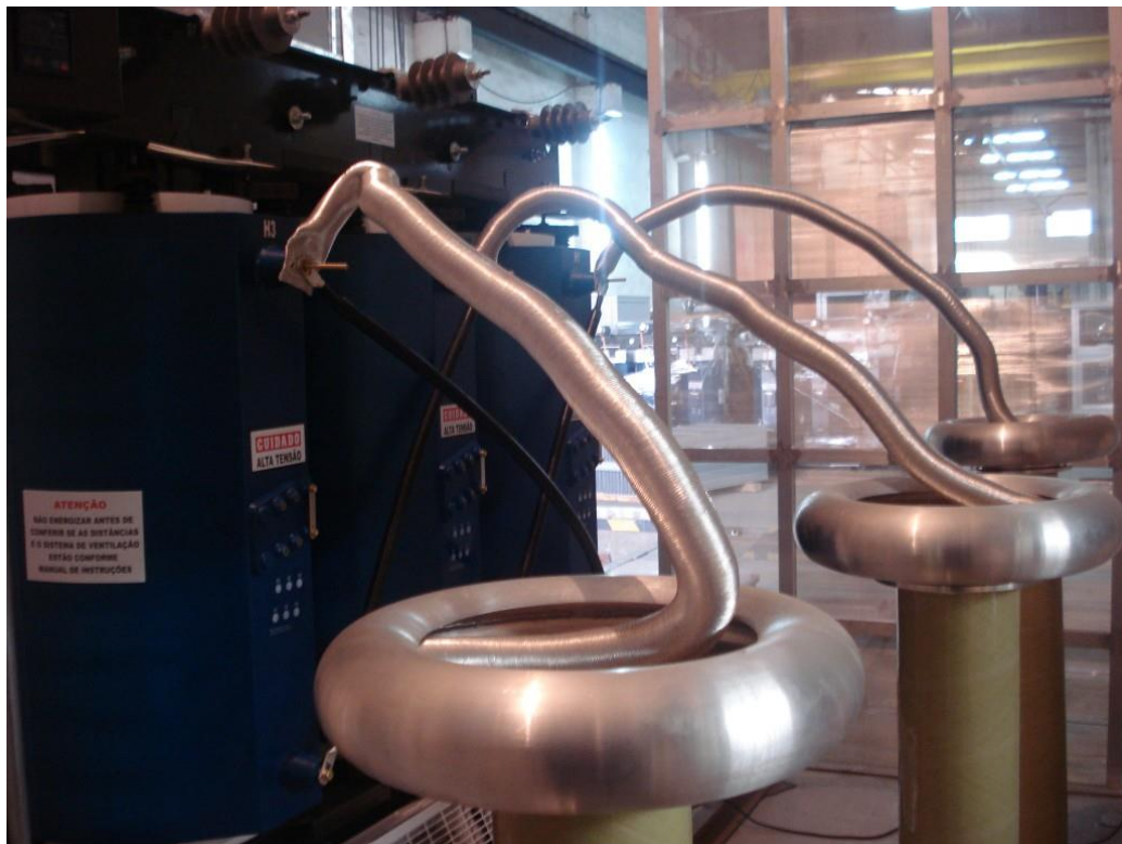
Figura 19 – Medição de descargas parciais.
