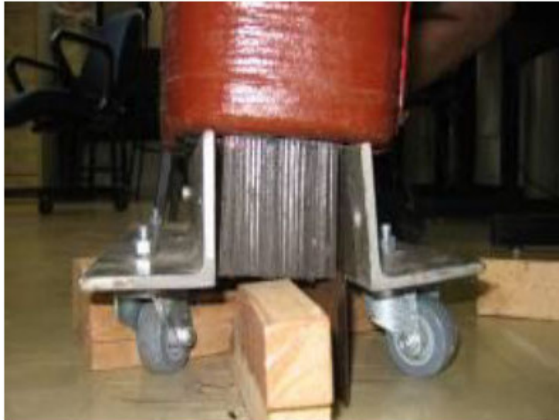
Fotografia 1 – Deslocamento de núcleo
