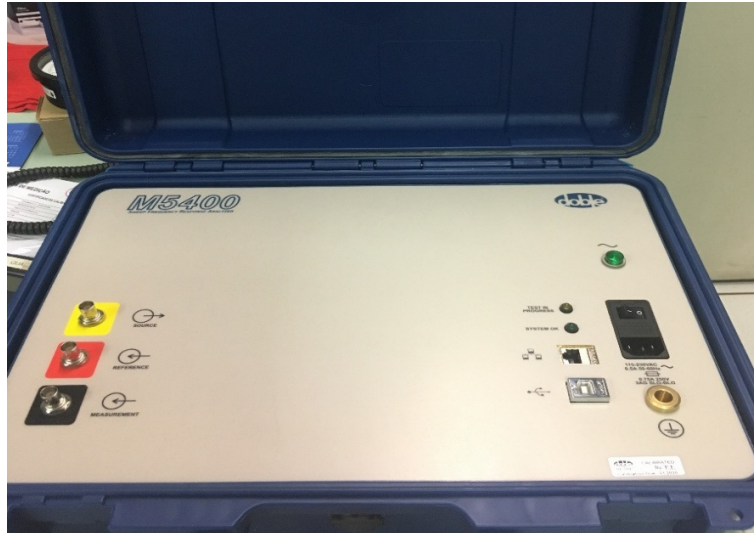
Fotografia 2 – Analisador de Resposta em Frequência de Varredura (SFRA) marca DOUBLE, modelo M5400
