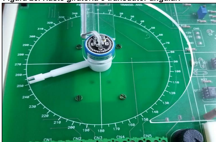
Figura 20. Haste giratória e transdutor angular.
