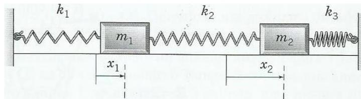
**Figura 2: Sistema com duas massas e três molas**
