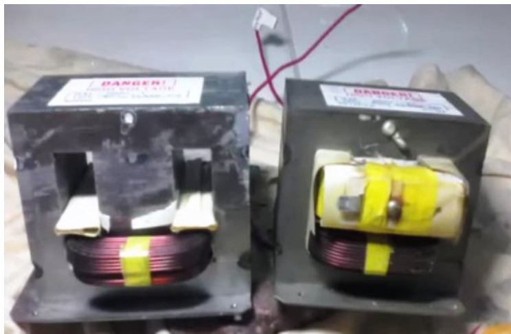
Figura 25 - Transformadores com Enrolamentos.
