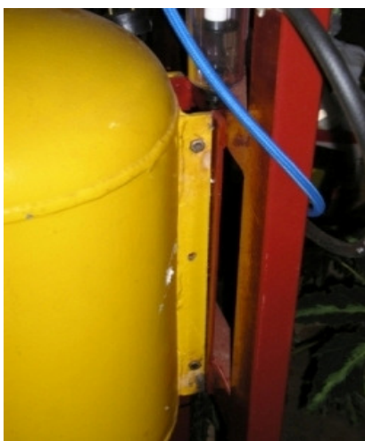
Figura 16 - Suporte Fixação Reservatório
