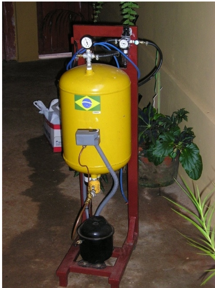
Figura 24 - Compressor de Ar Caseiro Finalizado.
