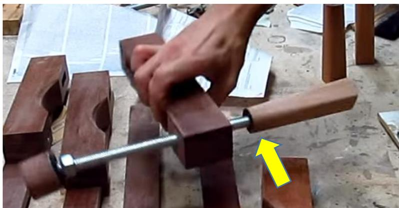
**FIGURA 69: Introdução da barra roscada ao furo do cabo**
