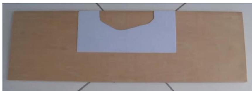
**FIGURA 18 – Demonstração da transferência de contorno (2)**
