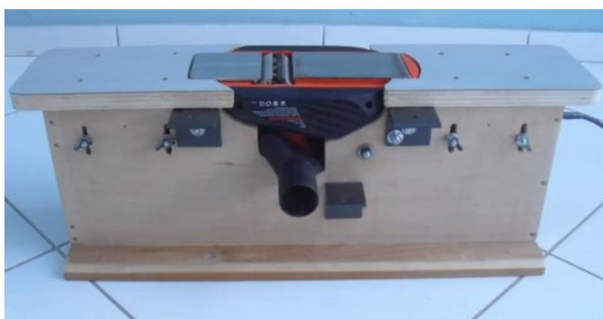
FIGURA 40 – Fixação da plaina elétrica na bancada (2)
