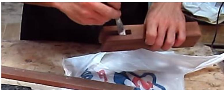
**FIGURA 49: Adicionando cola na parte interna da peça**
