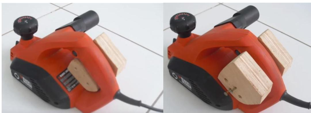
**FIGURA 29 – Encaixe dos tarugos na plaina elétrica**
