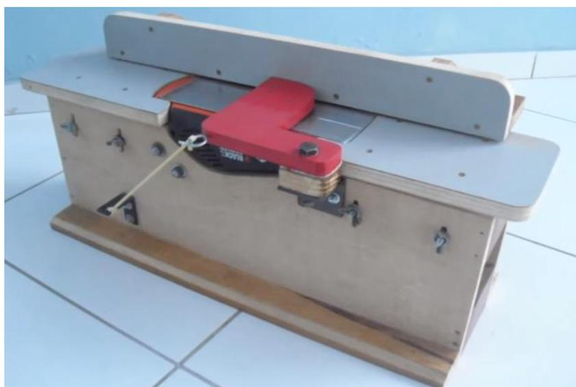
**FIGURA 43 – Fixação do guarda de segurança e tubo de látex**
