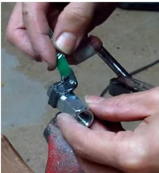
**FIGURA 54:** Adição de cola epóxi no pino
