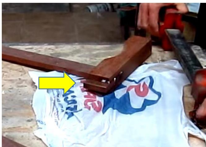
**FIGURA 51: Demonstração do local de encaixe**
