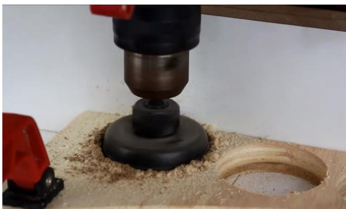
**FIGURA 72: Demonstração dos cortes ao compensado**
