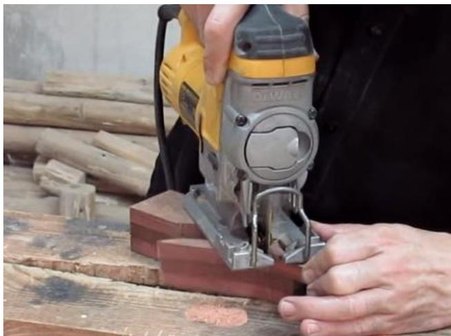
**FIGURA 48: Corte na lateral das peças**
