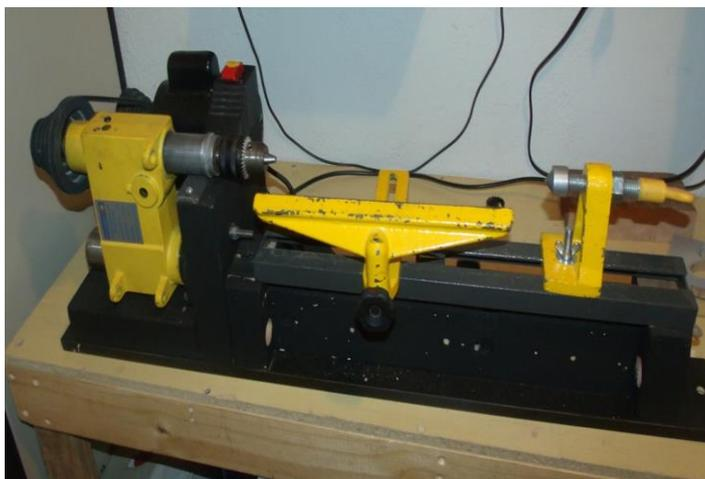
**FIGURA 85:** Figura demonstrativa do Mini Torno com Cabeçote de Furadeira
