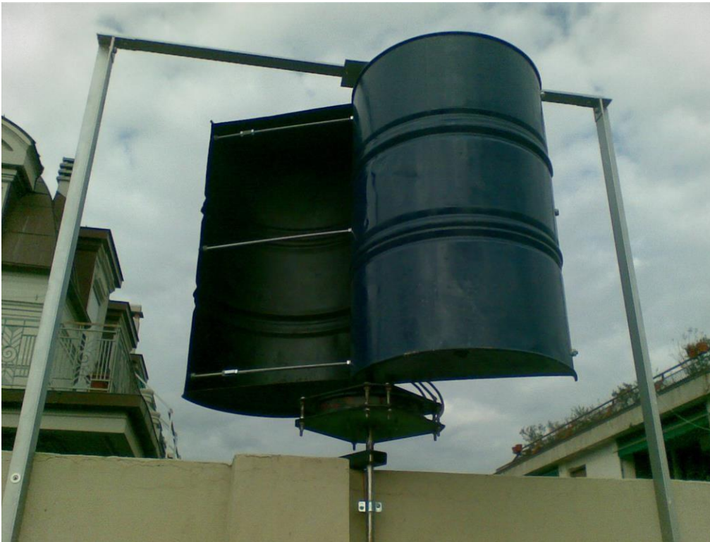
Figura 13 - Turbina feita com tonéis de metal. Fonte: Senso energia 2006
