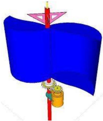
Figura 18 – Fixação da turbina ao alternador. Fonte: Isac Péricles 2014.
