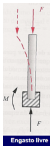
Figura 48 - Influência da condição de contorno do metalon ( L_{ef} = 2.L ). Fonte: adaptado HIBBELER, 2004.
