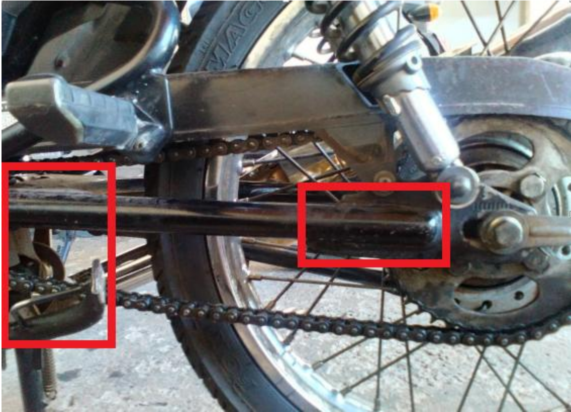
Figura 15 - Vista lateral com destaque para ressaltos na balança e cavalete central. Fonte: Autoria própria.
