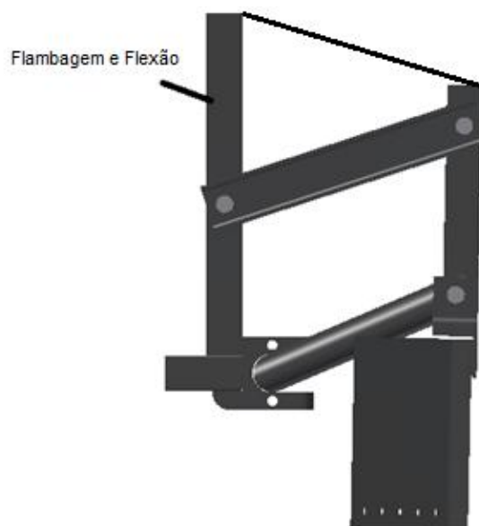
Figura 46 - Análise de tensão no tubo de sustentação do conjunto. Fonte: Autoria própria
