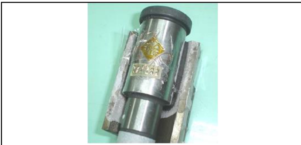
Figura 28 - Corpo de prova com roseta retangular e terminais para instrumentação. Fonte: Farias et al. (2009, p. 3).
