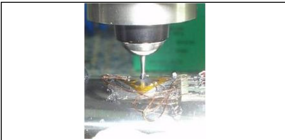
Figura 29 - Detalhamento da furação do corpo de prova. Fonte: Farias et al. (2009, p. 3).
