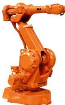
**Figura 1- Manipulador em Série: Robô de Soldagem à Laser.**
