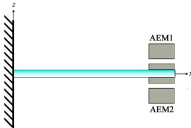
Figura 9 - Posicionamento dos atuadores eletromagnéticos na viga de material compósito em engaste-livre Fonte: Aatoria própria.
