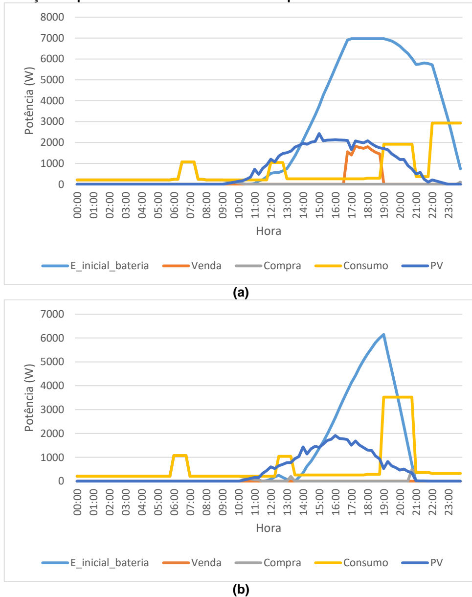
Figura 12. Resultados do caso de estudo 4 aplicado à tarifa convencional: (a) simulação do primeiro dia do caso de estudo 4 aplicado à tarifa convencional no verão, (b) simulação do primeiro dia do caso de estudo 4 aplicado à tarifa convencional no inverno.
