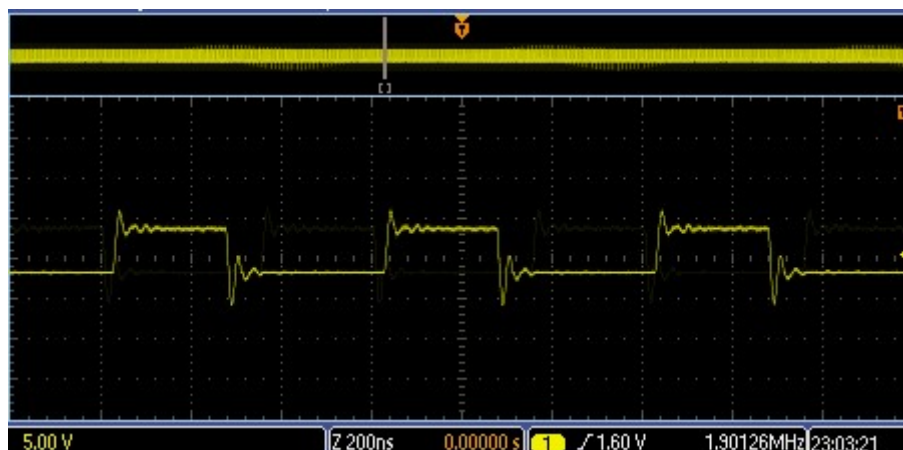
Figura 51 - Forma de onda do sinal da portadora.
