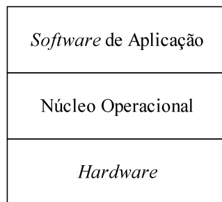
Figura 3 – Modelo de arquitetura de sistemas embarcados Fonte: Adaptada de Noergaard (2005)
