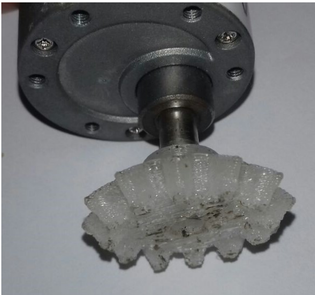
Figura 48 – Impressão em 3D do pinhão do motor.
