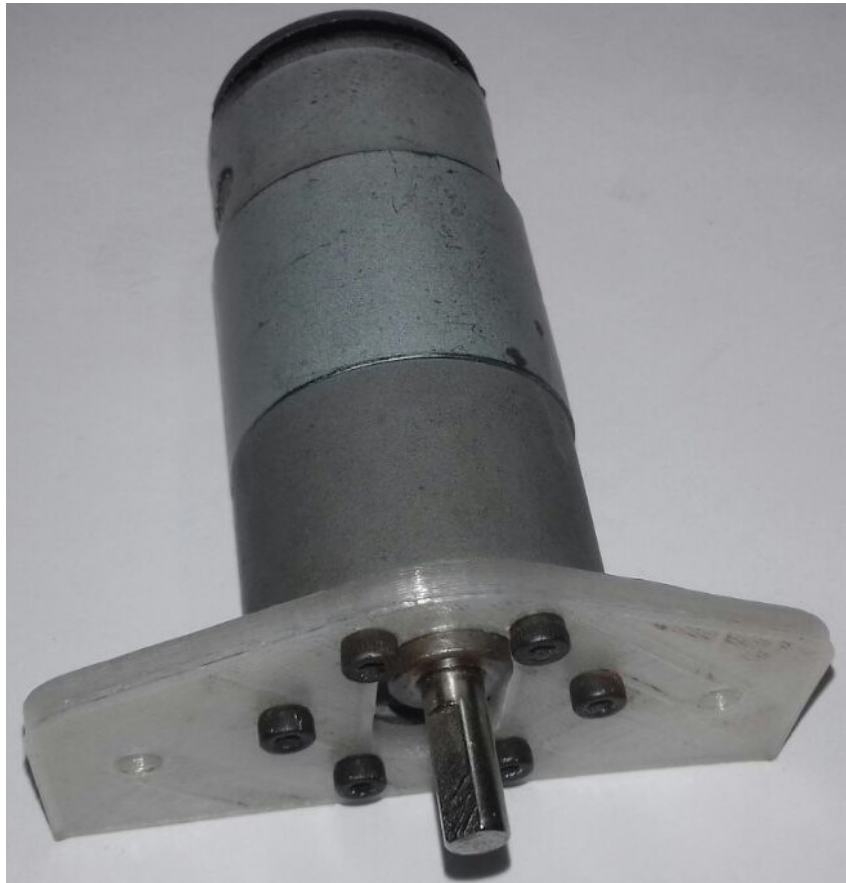
Figura 43 – Impressão em 3D do apoio do elo 2.
