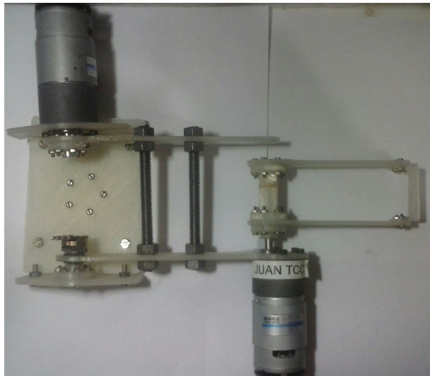
Figura 47 – Impressão em 3D dos elos 2 e 3.
