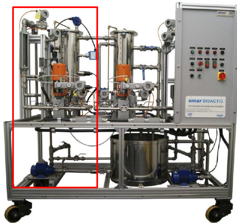
Figura 8 – Malha de aquecimento da planta didática industrial. Fonte: Adaptado de SMAR (2012).
