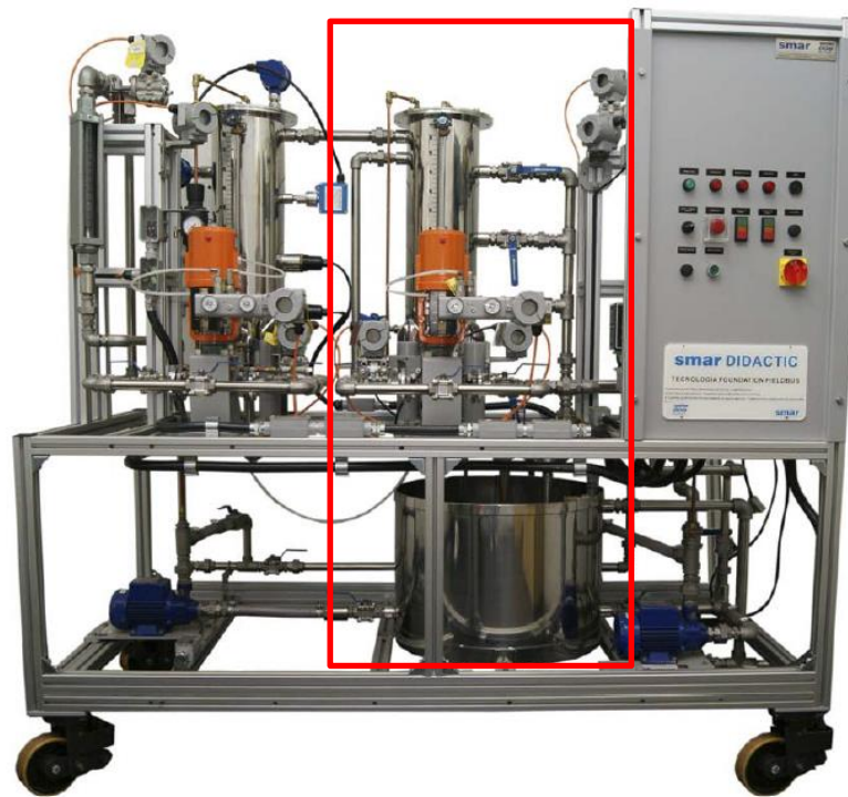
Figura 9 – Malha de mistura da planta didática industrial. Fonte: Adaptado de SMAR (2012).
