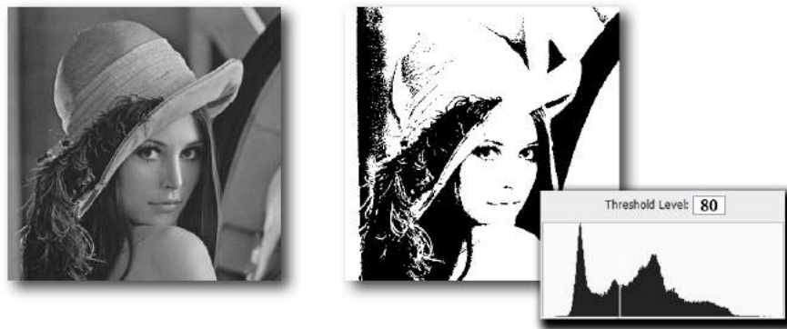
Figura 12: Aplicação da limiarização com o limiar em 80.
