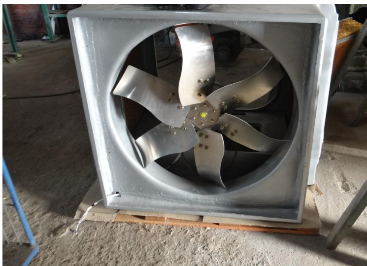
Figura 02- Climatizador após finalização do processo de montagem. Fonte: Climatizadores Perferro (2014).
