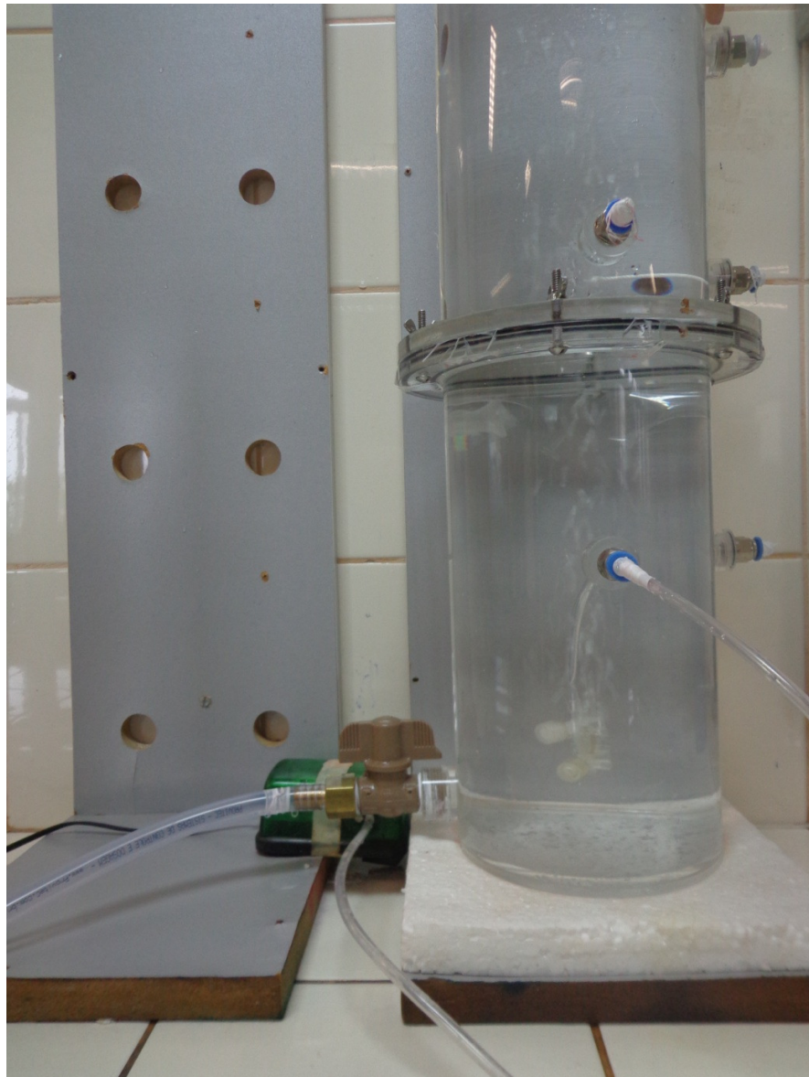
Figura 4 - Sistema de injeção de ar no interior do reator UASB em escala de bancada.
