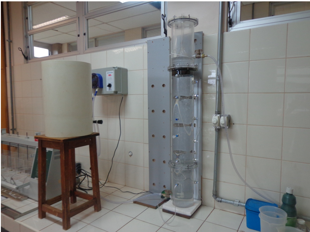
Figura 3 - Reator UASB em escala de bancada construído em plexiglass .
